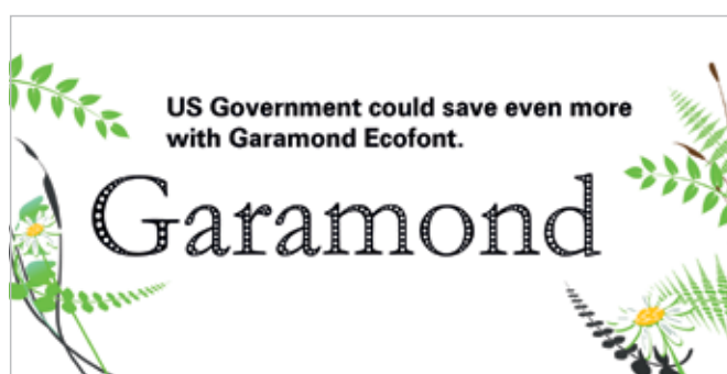
Abb. 2: Die Ecofont Software stanzt Löcher exakt auf der Schriftlinie
